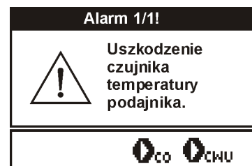
Rys. 52 Widok alarmu „uszkodzenie czujnika podajnika”
