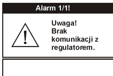
Rys. 53 Widok alarmu „brak komunikacji”
