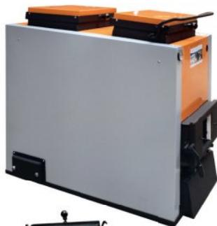
Kotlovi na drvo vrste Kumulator Eko su uređaji s donjim izgaranjem. Ovaj sustav omogućava precizno i sporije (a time i ekonomičnije) izgaranje goriva. Ispušni plinovi cirkuliraju kroz kotao preko 3 dimna kanala za ispušne plinove, što znatno povećava prijeđenu putanju te samim time povećava učinkovitost prijenosa topline.
